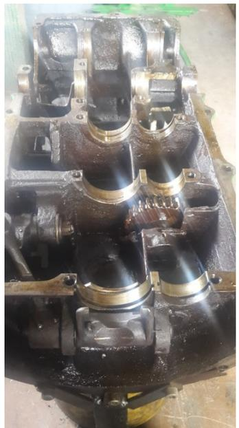
1 - Parte inferiore della scatola del cambio che funge da supporto per ingranaggi (foto sotto) e differenziale.
