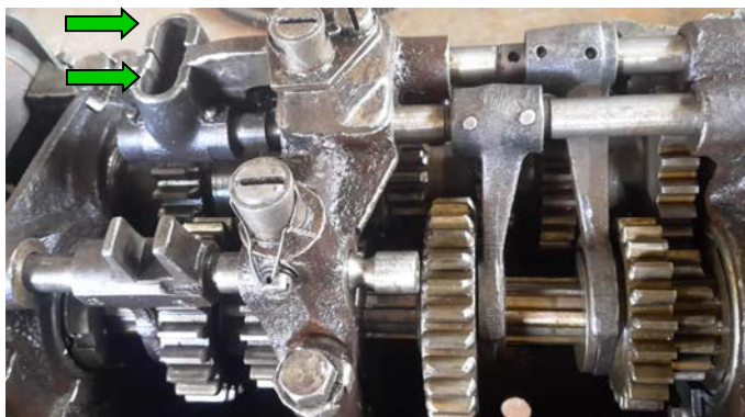
5 - Le frecce indicano i due naselli di scorrimento per le forcelle del comando ingranaggi.
