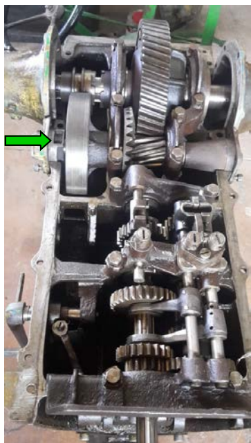
3 - Parte inferiore della scatola del cambio con albero primario. La freccia in basso indica la posizione dell'albero. La freccia in alto indica la posizione del freno.
