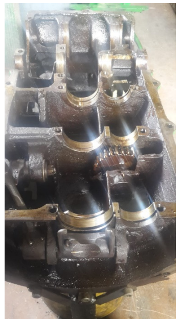
1 - Parte inferiore della scatola del cambio che funge da supporto per ingranaggi (foto sotto) e differenziale.
